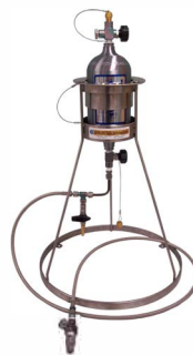
CILINDRO DE RECOGIDA DE LÍQUIDOS DE 1 LITRO CON LÍNEA DE TRANSFERENCIA / MONTAJE DE PURGA Y VC-VERSIPAD
