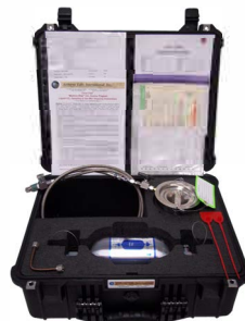
KIT DE RECOGIDA DE CO 2 LÍQUIDO (ABIERTO)
