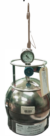
LATA SUMMA DE 6 LITROS PARA LA TOMA DE MUESTRAS DE AIRE AMBIENTE
