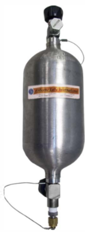
CILINDRO DE MUESTREO DE 1 LITRO
